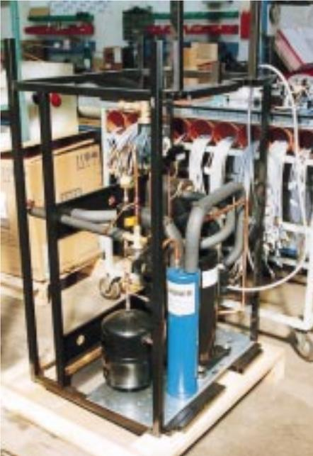
Der Gasphasenmanager von Ochsner erhöht die Betriebsicherheit und die Leistungsziffer der Wärmepumpenanlage
