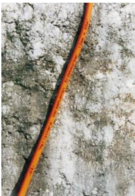
Flachkollektoren für direkt verdampfendes Kältemittel sind Erdabsorber aus PE-ummanteltem Kupferrohr gemäß DIN 59753 (Kühlschrankqualität), 12 mm im Durchmesser
