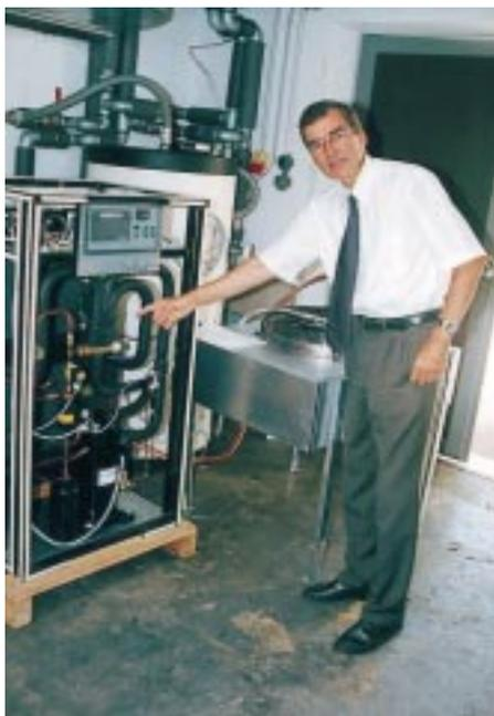
Direktexpansion ist bei Ochsner auch mit der Wärmequelle Luft gegeben. Diese Split-Wärmepumpe hier im Versuchsraum eignet sich sowohl für die Fußbodenbeheizung als auch im Sommer für das Kühlen
